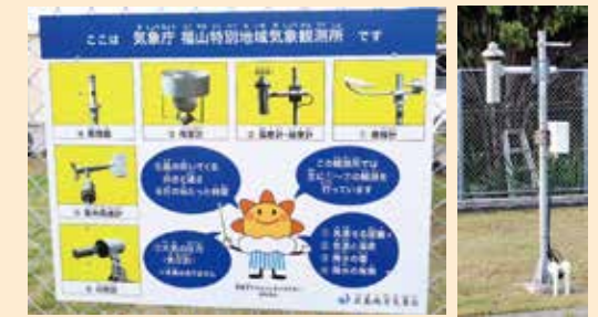
右は、②の温度計・湿度計の実物写真です (図に合わせるため左右反転)
